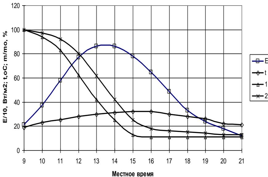
E – плотность интегральной солнечной радиации; t – температура окружающего воздуха
