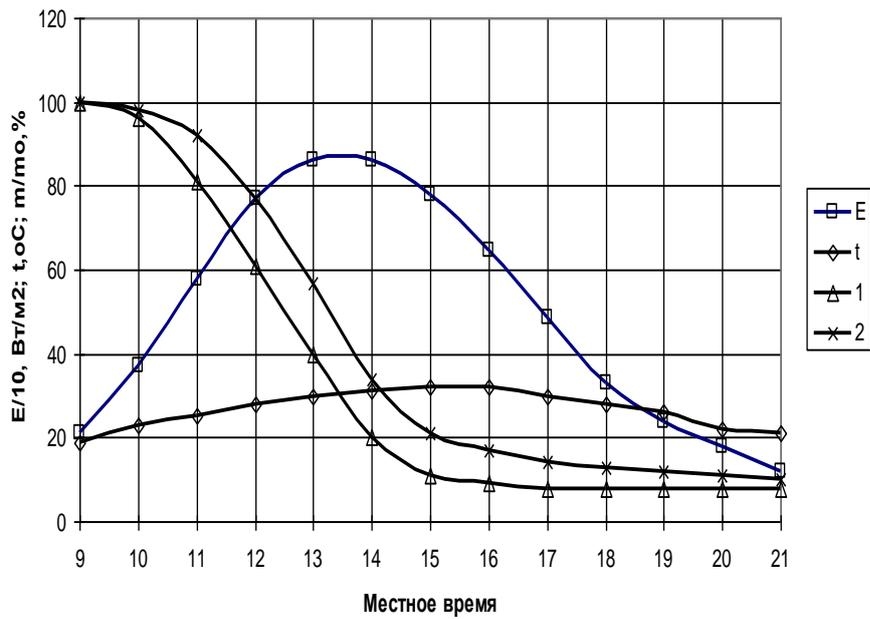
E – плотность интегральной солнечной радиации; t – температура окружающего воздуха
