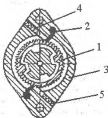
Рис. 2. Поворотный механизм с двумя собачками в корпусе: 1-храповое кольцо; 2-собачка; 3 - букса; 4 - плунжер; 5-пружина.
