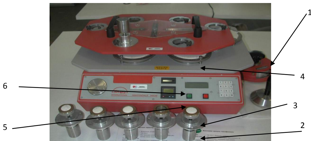
Рисунок 2 - На приборе испытываемый образец истирается в разных направлениях
