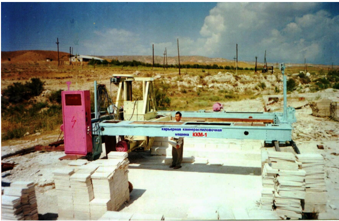
Рис. 2. Карьерная камнераспиловочная машина ККМ-1 при получении изделий на карьере «Ак-Таш».
