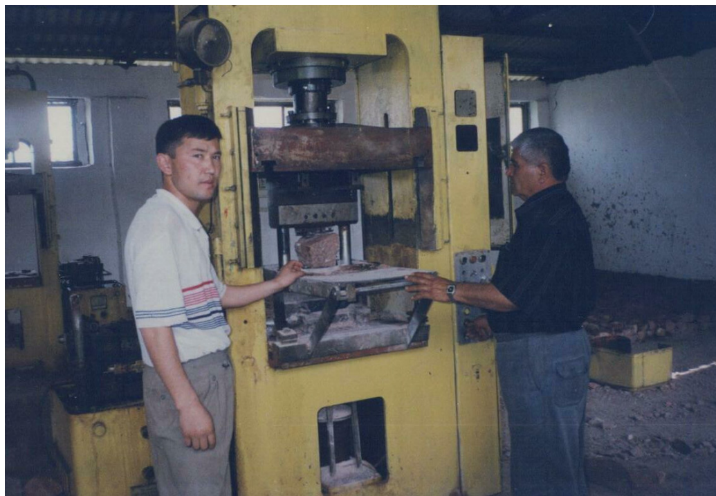
Рис. 2. Конструкция гидравлического камнекольного пресса ГКП-100
