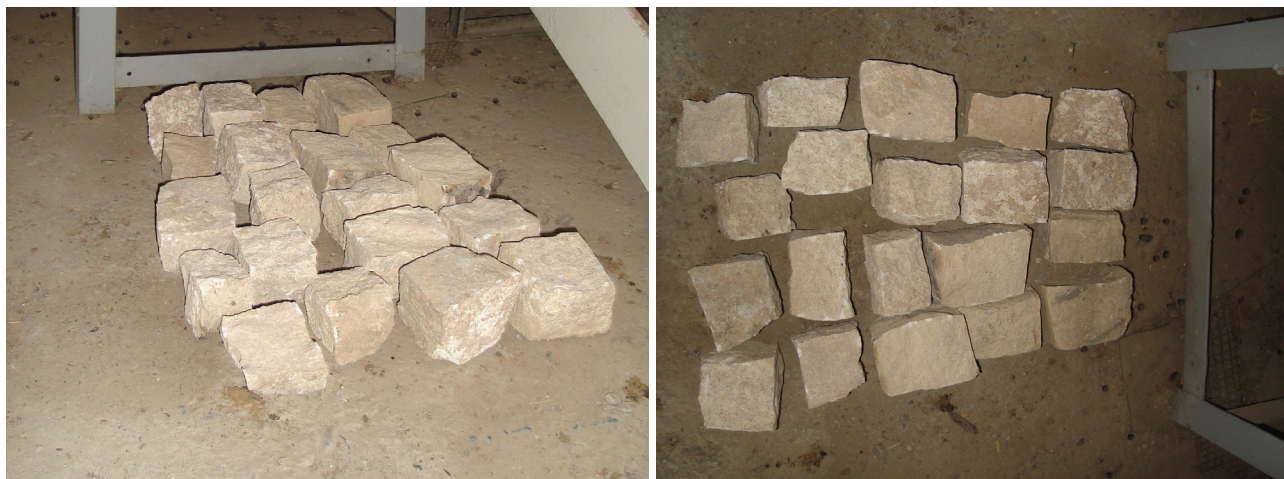
Рис. 2. Раскол камня винтовым камнекольным прессом ВКП-50
