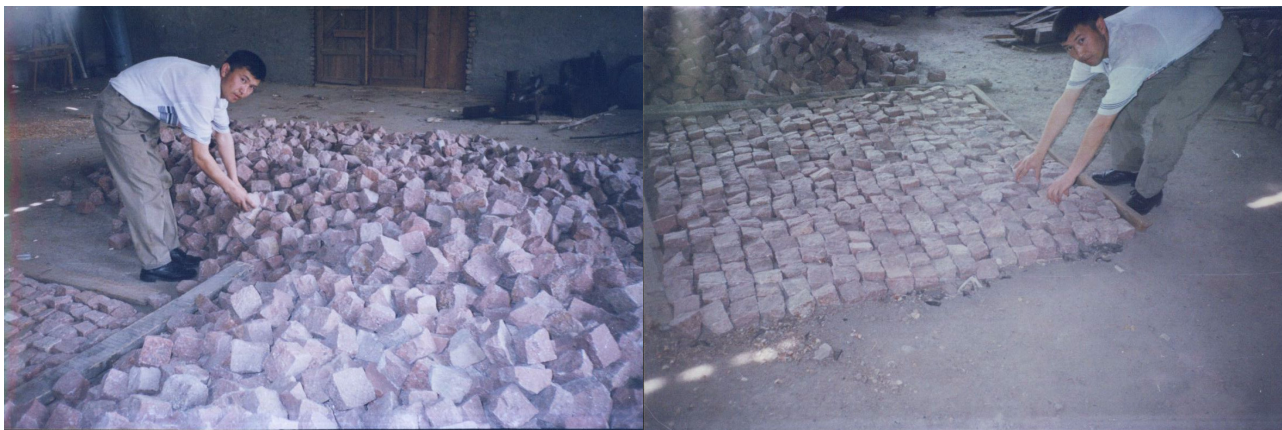
Рис. 4. Вид брусчатых камней, изготовленных в ходе промышленных испытаний гидравлического камнекольного прессы ГКП-100
