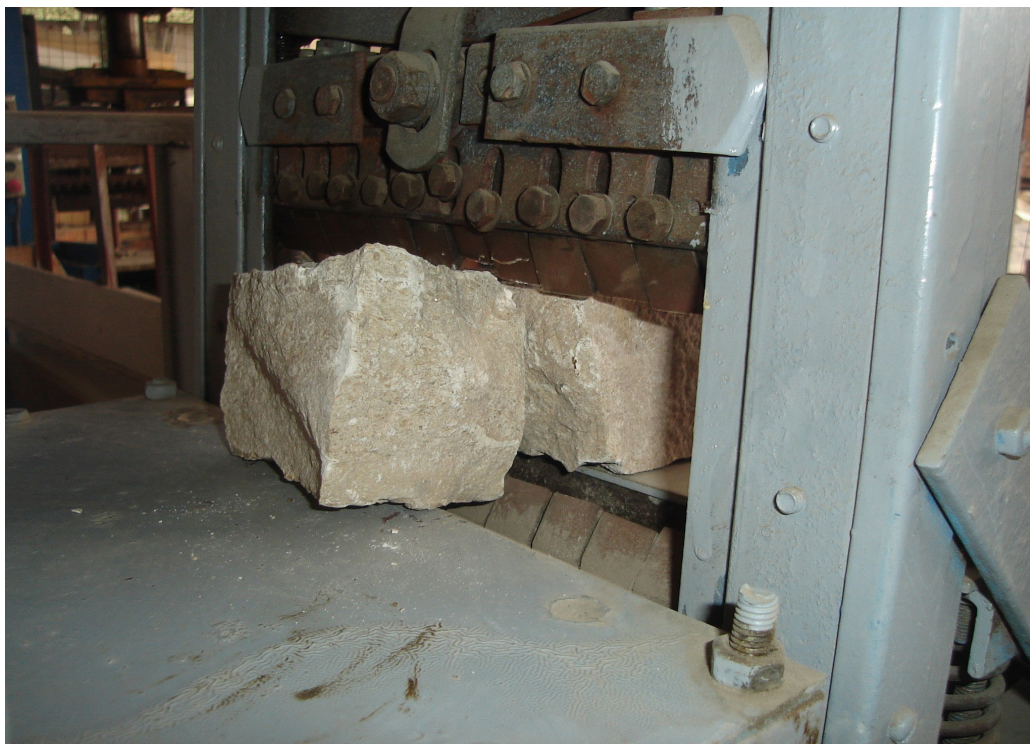
Рис. 2. Раскол камня винтовым камнекольным прессом ВКП-50
